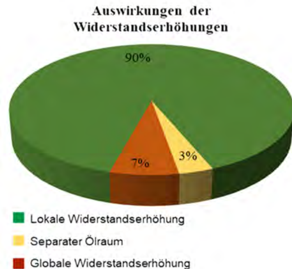
Bild 2: Ort und Art der beobachteten Wicklungswiderstandserhöhung
