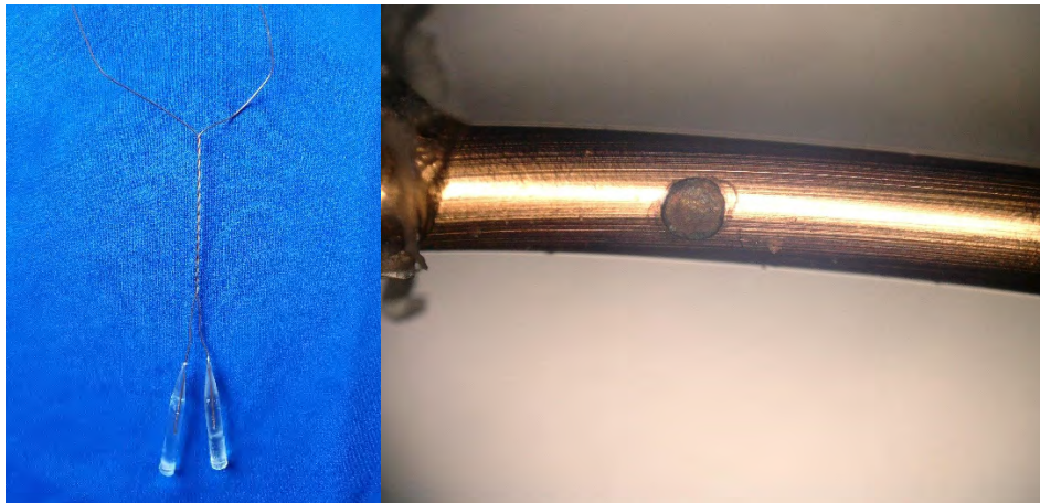
Bild 2: Prüfling mit konischer Feldsteuerung (links) und mikroskopischer Ansicht des Durchschlags (rechts)
