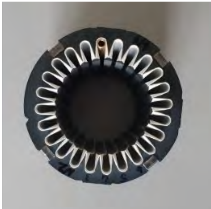
Bild 1: Stator mit Metallrohr als Gegenelektrode
