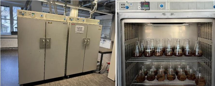
**Bild 2:** Wärmeschränke für thermische Alterungsversuche
