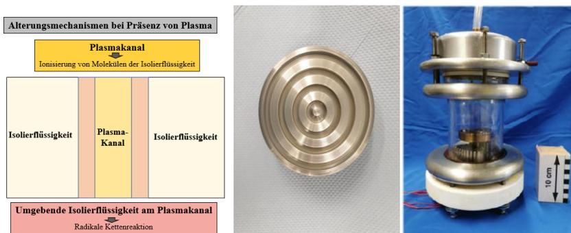
**Bild 1:** Alterungsmechanismen in Plasma (links) Prüfgefäß zur Nachbildung von TE (rechts)
